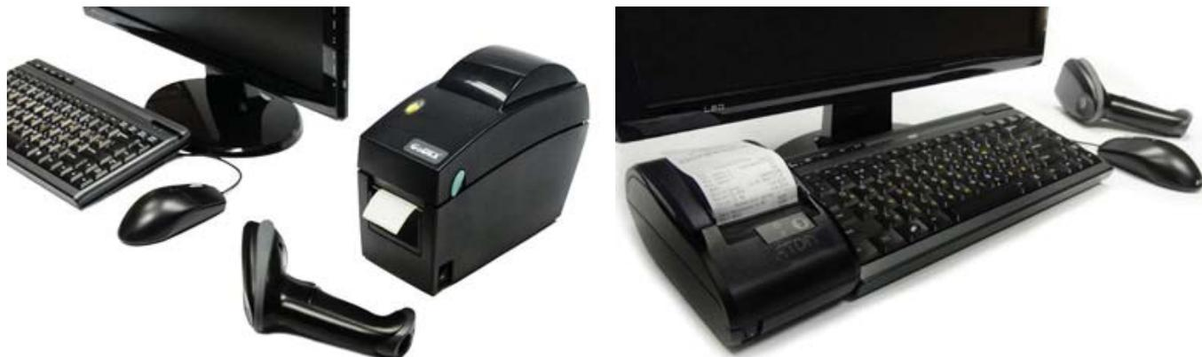
Решение "Front-Back" состоит из двух автоматизированных рабочих мест (кассира и товароведа), собранных на базе персональных компьютеров. Рабочее место кассира оборудовано компактным и мощным компьютером со сканером штрихкода и фискальным регистратором, а место товароведа еще более мощным компьютером со сканером штрихкода и принтером этикеток.
